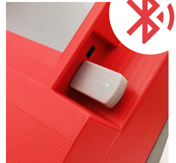
Puerto USB Bluetooth para programar a través de la aplicación Android
